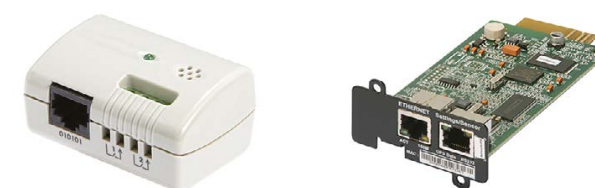
Адаптер Web/SNMP с датчиком параметров окружающей среды.
